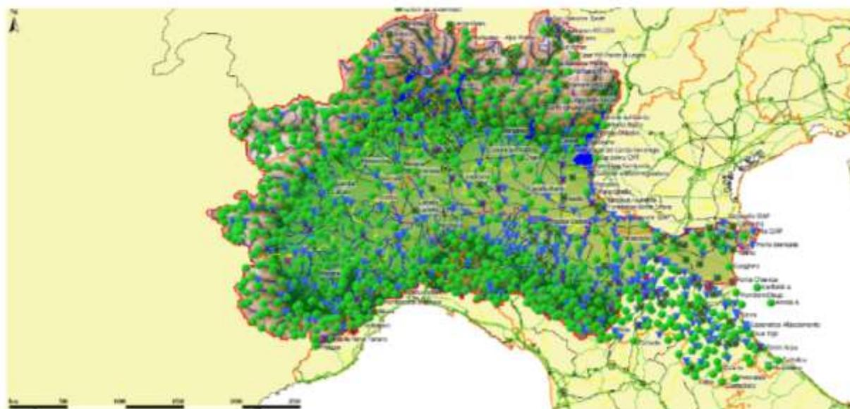
FIGURA 8.26 RETE DEI SENSORI IDROMETRICI E PLUVIOMETRICI REGIONALI PRESENTE NEL DISTRETTO DEL FIUME PO UTILIZZATA PER IL MONITORAGGIO FINALIZZATO A TUTTE LE ATTIVITÀ DI PIANIFICAZIONE E GESTIONE DEGLI EVENTI DI MAGRA E PIENA.
