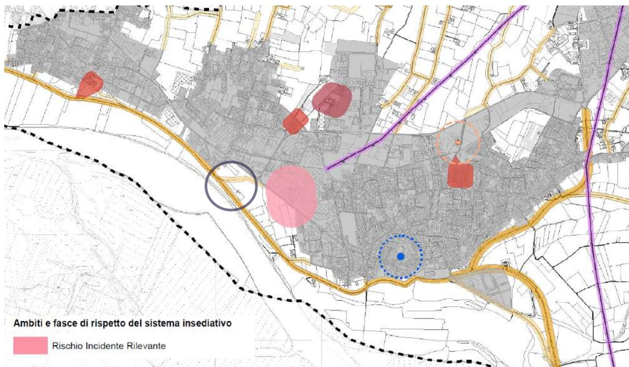
FIGURA 8.35 ESTRATTO DELLA TAVOLA DA.02 VINCOLI E PIANIFICAZIONE SOVRACOMUNALE CHE INDIVIDUA IL VINCOLO DERIVANTE DALL'ELABORATO RIR CON INDICAZIONE DELLE DISTANZE DI SICUREZZA.
