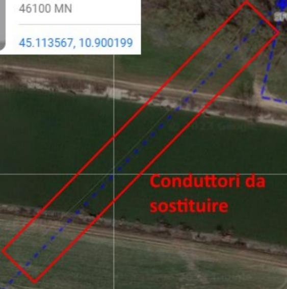
Conduttori da sostituire
