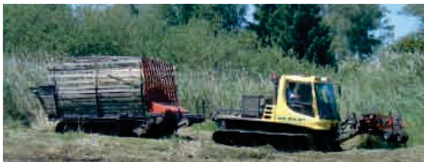
Figura 6. Esempio di macchinario ideale per lo sfalcio del canneto con rimozione dei resti. Battipista Kässbohrer Pisten Bully attrezzato con rimorchio raccogliatore cingolato e andanatrice dalla ditta NUP (Svizzera). Macchina andanatrice-raccogliitrice. (Foto D. Cuizzi)
