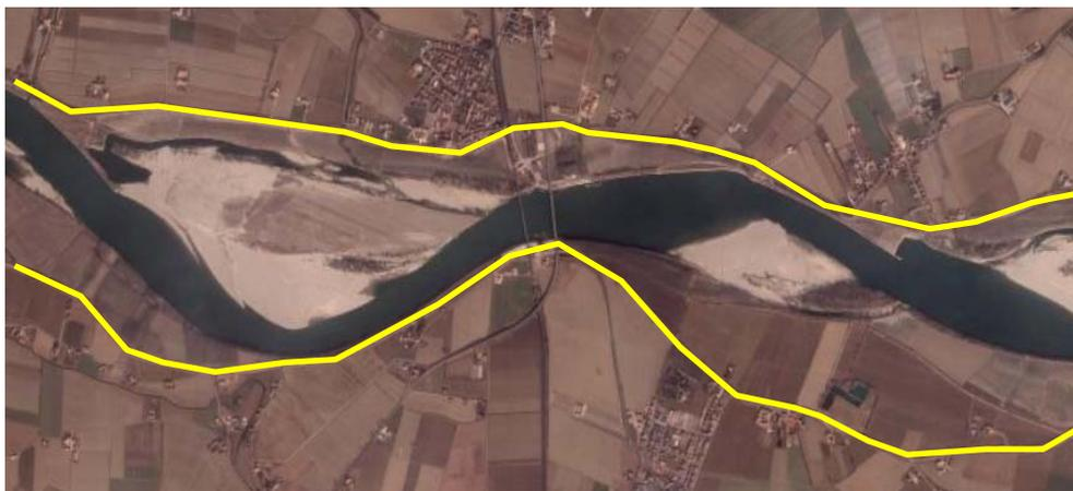
**Figura 1.3. Attraversamenti del Po in prossimità di Borgoforte. Il corso del fiume è da sinistra verso destra. Le linee gialle identificano gli argini di fascia B.**
