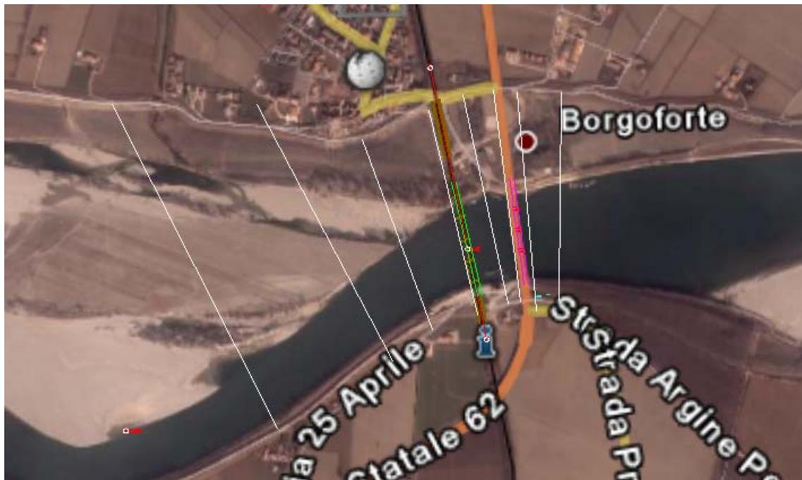
Figura 4.15. Posizione delle sezioni (linee bianche) rilevate nel mese di ottobre 2007. Le sezioni sono indicate con i numeri da 1 a 8 partendo da monte (sinistra) verso valle (destra).
